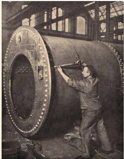
Handwerkliche Kesselfertigung bei Piedboeuf Quelle: © Salzgitter AG-Konzernarchiv/Mannesmann-Archiv in Mülheim an der Ruhr
